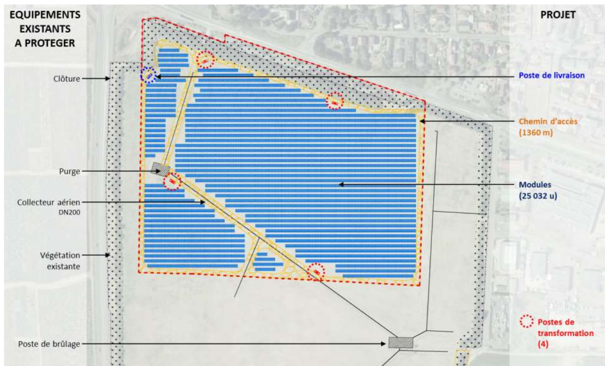
Fig. 4. Plan masse de l'installation projetée
