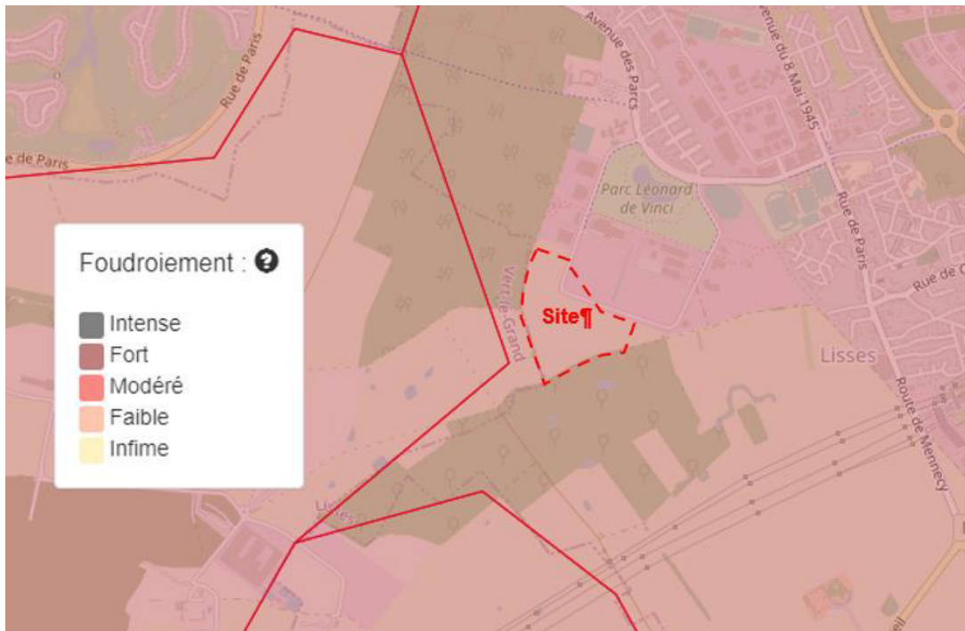
Figure 11 : Niveau de foudroiement au niveau du site du projet à Lisses – Niveau faible
