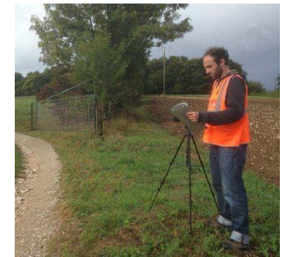
Etudes de vibrations et des bruits lors du fonction de l'engin muni d'une dent de déroctage vibrante (sources : Innogéo et Sciences Environnement)
